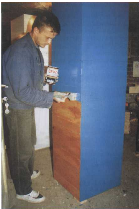
Сл. 176. Кошнице прво премазујемо врелим фирнајзом па затим два пута фарбом
